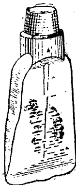
Фиг. 11. Долото, готовое для обрубки его отжатой части.
